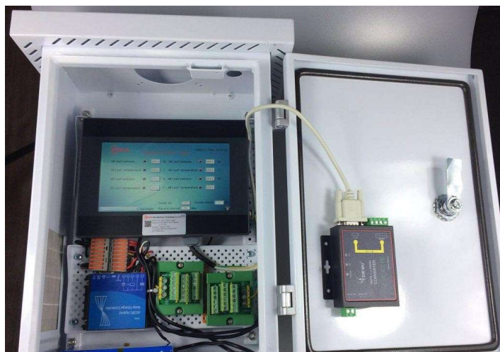
Рисунок 1 - Внешний вид логгера данных ICB600-07
